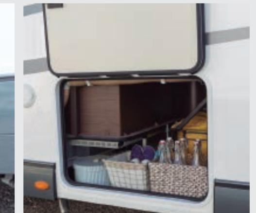
8 AL-KO Chassis mit durchgängig doppelten Boden.
